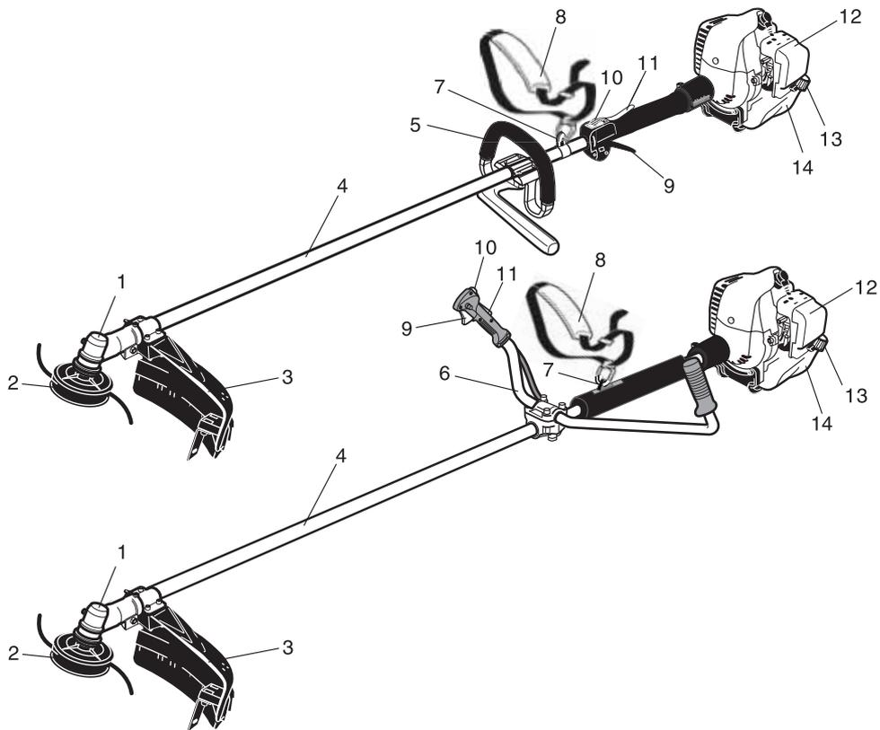
1. **Renvoi d'angle.** Avec deux engrenages pour changer l'angle de l'axe de rotation.
