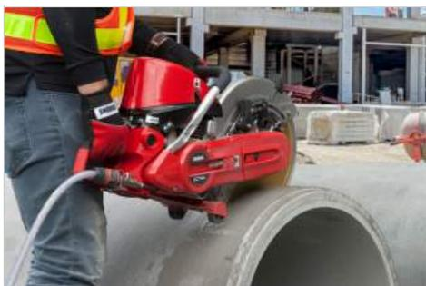
Disqueuse avec système de filtration en 4 étapes.
