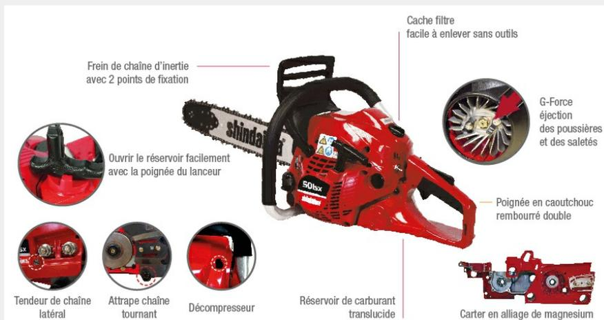
Optimisation du rapport poids / puissance. L'amélioration des performances est possible grâce à un certain nombre d'ajustements du moteur: optimisation du refroidissement du piston, ajustement des orifices de transfert dans le cylindre et une modification au vilebrequin.
